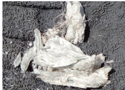
検出されたアスベスト（石綿）
