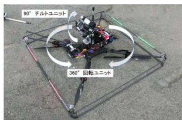
ドローンによる橋梁点検
